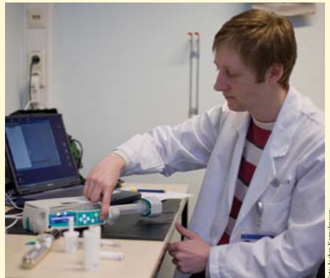
Der richtige Druck: Medizintechniker Morten Bilow (KME) kalibriert den Antrieb einer Infusionsspritzenpumpe von Braun.
