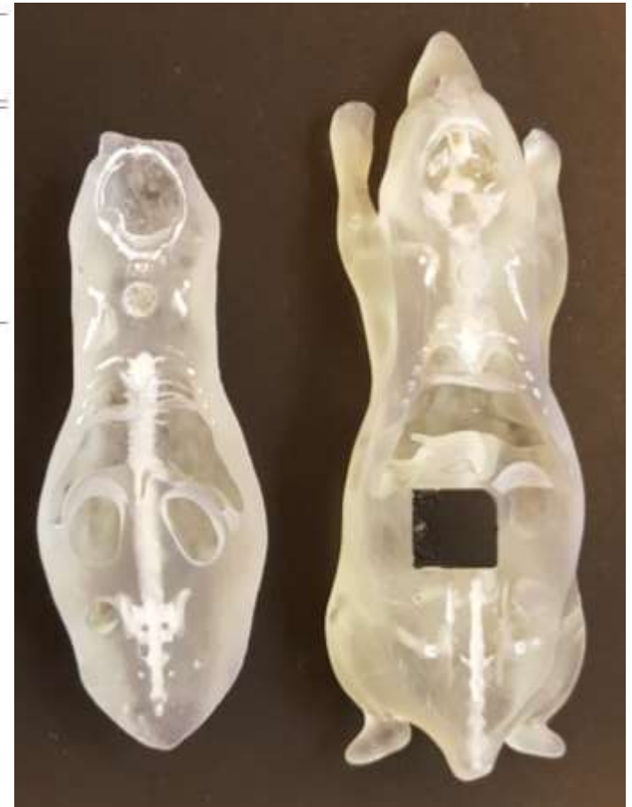
Maus-Phantom Prototyp 1 mit Gips-Füllung und OSL-Dosimeter
