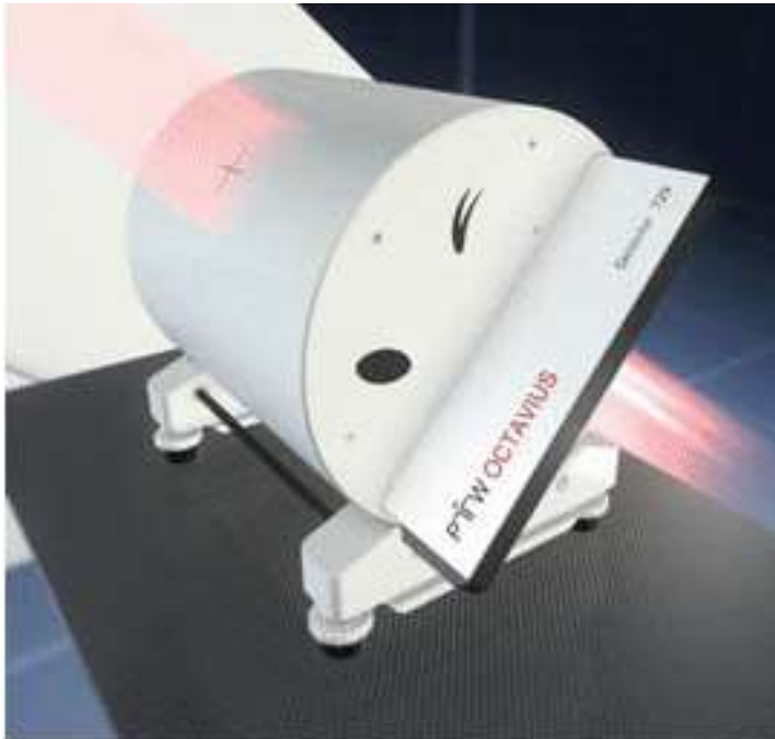
Phantom mit OCTAVIUS Detector 729: 27 x 27 Kammern, 10mm Abstand)
