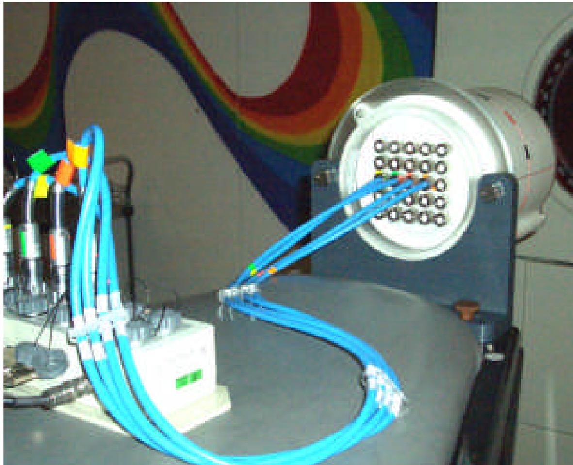
**PTW-Matrix-phantom mit Kammerbestückung in Kalibrierposition**
