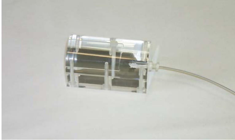
Abbildung 5.1: Abgebildet ist das Meßphantom der Firma Guidant zur Dosimetrie an der ^{32}\text{P} -Quelle. Das Phantom besteht aus Plexiglas. Gut zu erkennen ist die Plastikschraube, die zur Filmmarkierung dient und die Aussparung für den Film. Der GafChromic Film wird von links in das Phantom eingeführt und dann mit der Plastikschraube fixiert und markiert. Von rechts wird der Quellendraht durch den Katheter in das Phantom gefahren.
