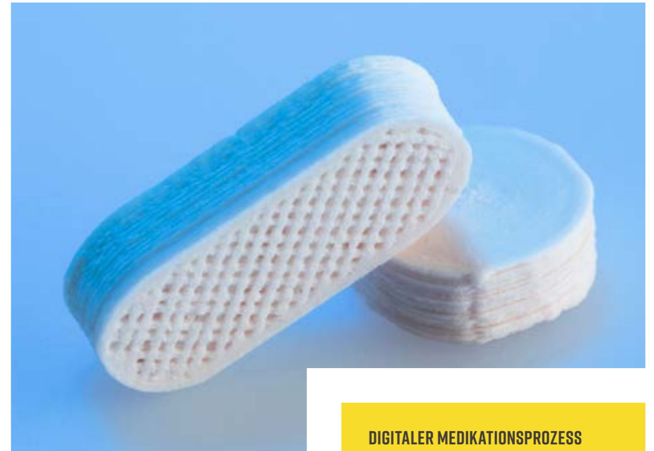
Der 3D-Drucker produziert die zuvor definierte Menge an Tabletten, deren Dosis individuell auf die Patient:innen abgestimmt ist
